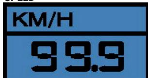
Anzeige der Geschwindigkeit in km/h (0-99.99km/h). Es handelt sich um einen theoretischen Annahmewert, welcher nicht mit dem Wert eines normalen Fahrrades verglichen werden kann.
